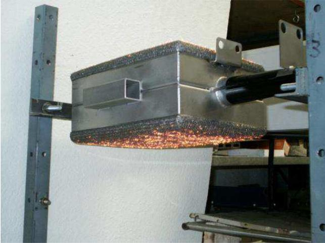
**Outillage sur magasin:** chauffe de 2 outils en acier de 400x400x250mm ( $\approx 310$  kg/unitaire) écartés de 200mm avec un radiant infrarouge gaz de 350x350mm.
