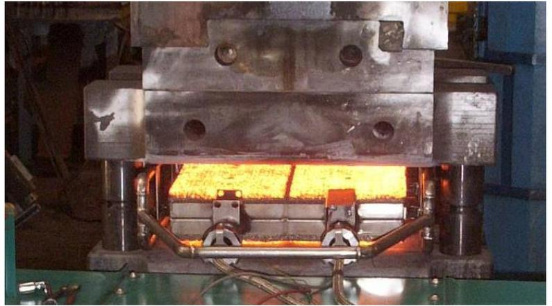
*Radiant double face intégré directement dans l'outillage de la presse*
