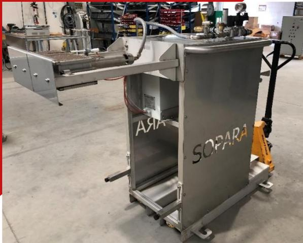
*Chariot mobile permettant la mise en place rapide du radiant entre les outils*
